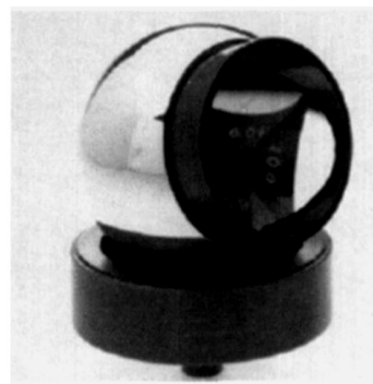
图 1 角锥棱镜反射器
